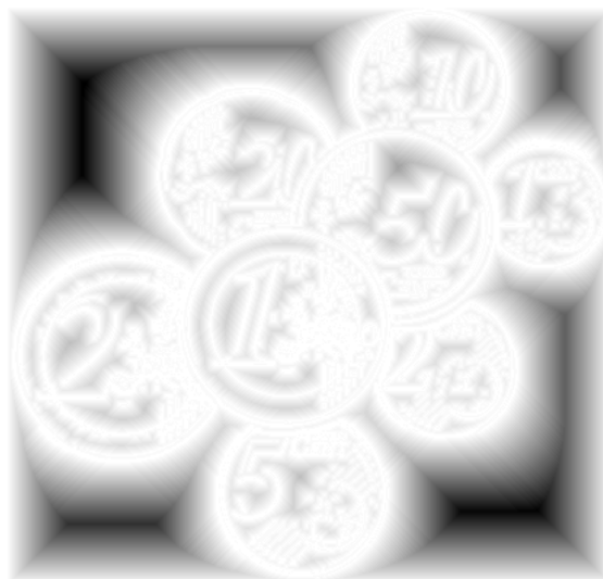
FIGURE 2.14 – Partage des eaux avec le principe de bassins
